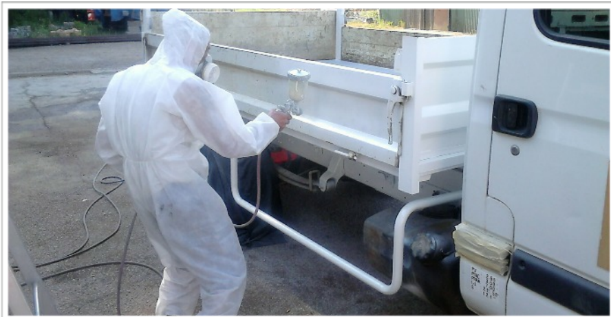
Afin de conserver le matériel mis à sa disposition, le service technique a entrepris la remise en état de bennes de petits camions. En effet, celles-ci étaient rongées par la rouille sous l'effet du sel de déneigement.
