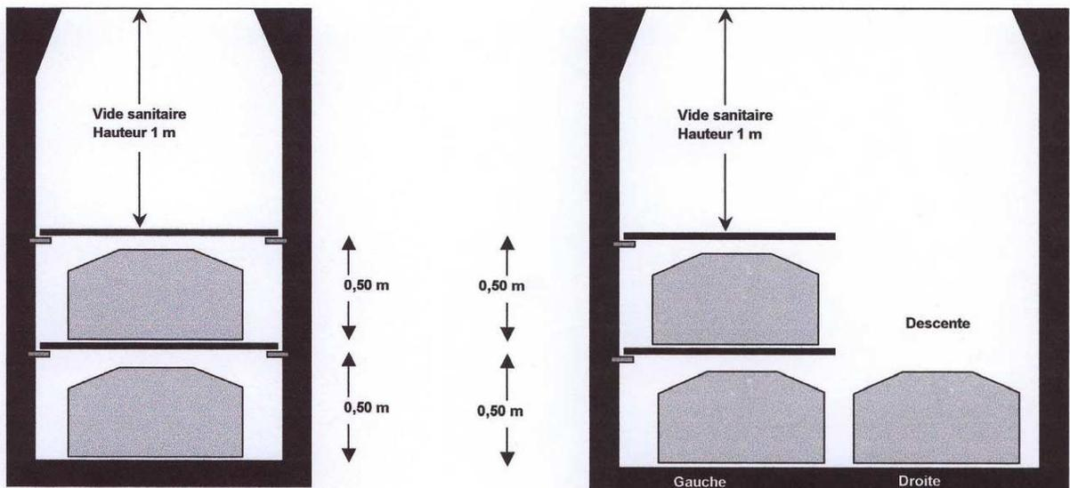
Un vide sanitaire d'au moins un mètre de hauteur est réservé à partir du niveau du sol dans la partie supérieure d'un caveau (mesure prise au point d'affleurement de la partie supérieure du caveau à la ligne de pente naturelle du terrain).
